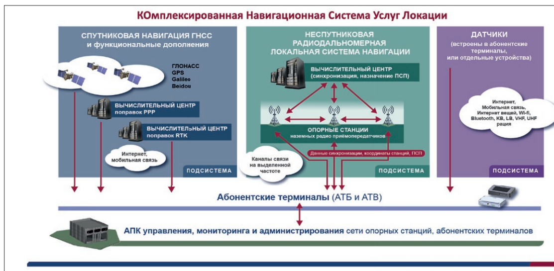
Рисунок 1. : Комплексированная Навигационная Система Услуг Локации (КОНСУЛ). Источник: НИИМА «Прогресс»
