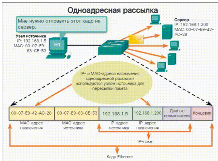
Рисунок 3. Демонстрация, как производится пересылка фрейма через коммутатор
