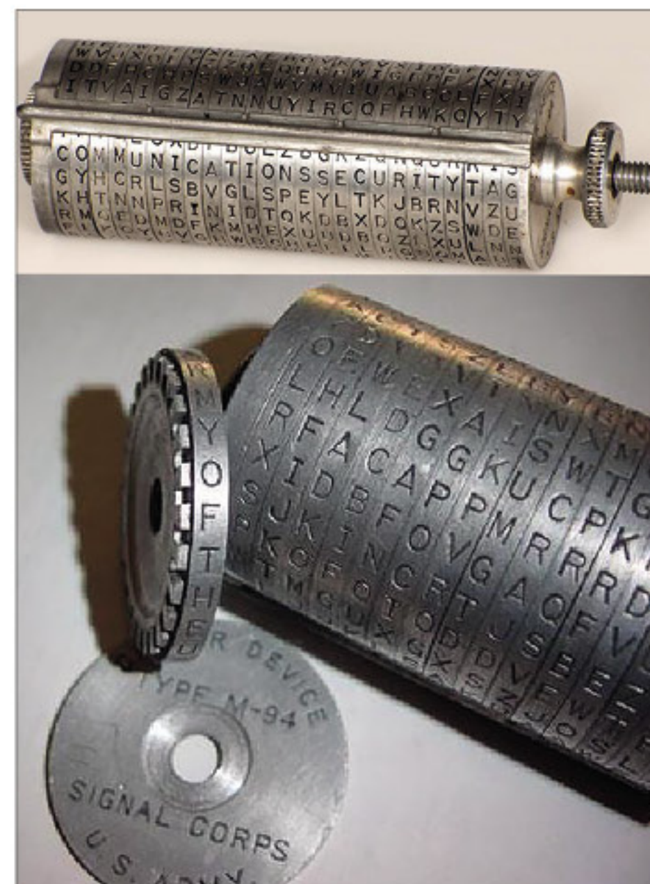
Дисковый шифратор M-94
