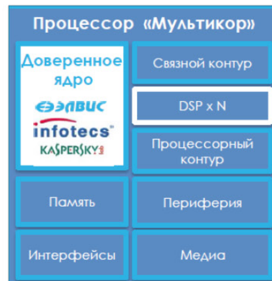
Рисунок 1. Блок-схема процессора Мультикор
