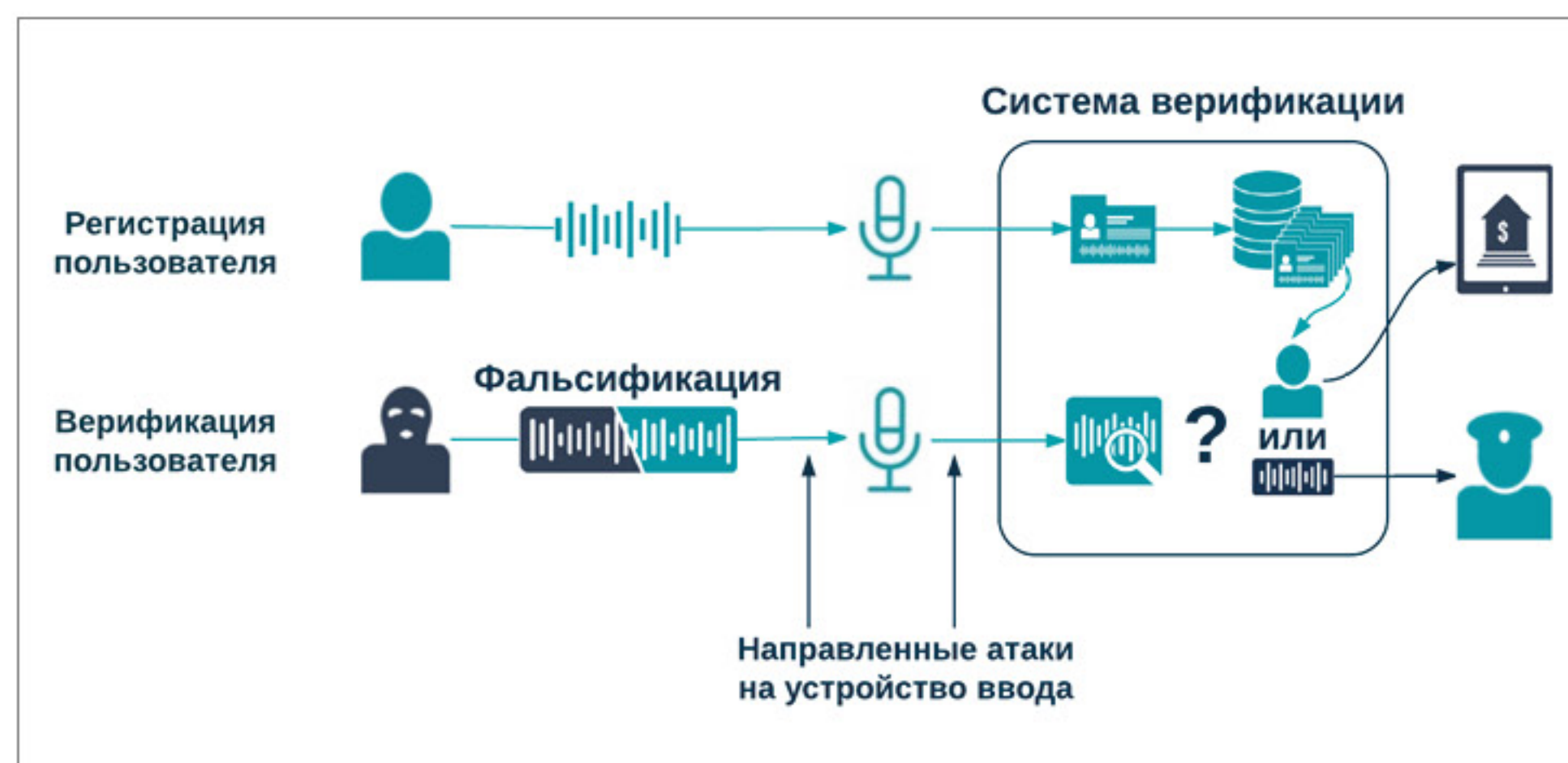
Рисунок 1. Схема направленных спуфинг атак на голосовую биометрическую систему
