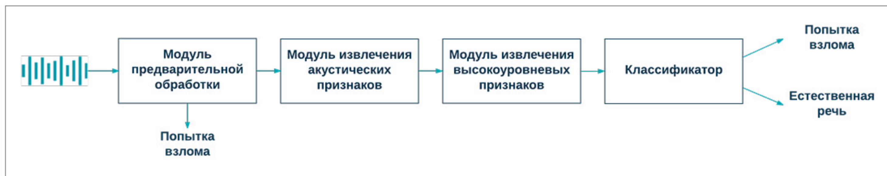
Рисунок 3. Обобщенная структура системы детектирования спуфинг атак на голосовые биометрические системы
