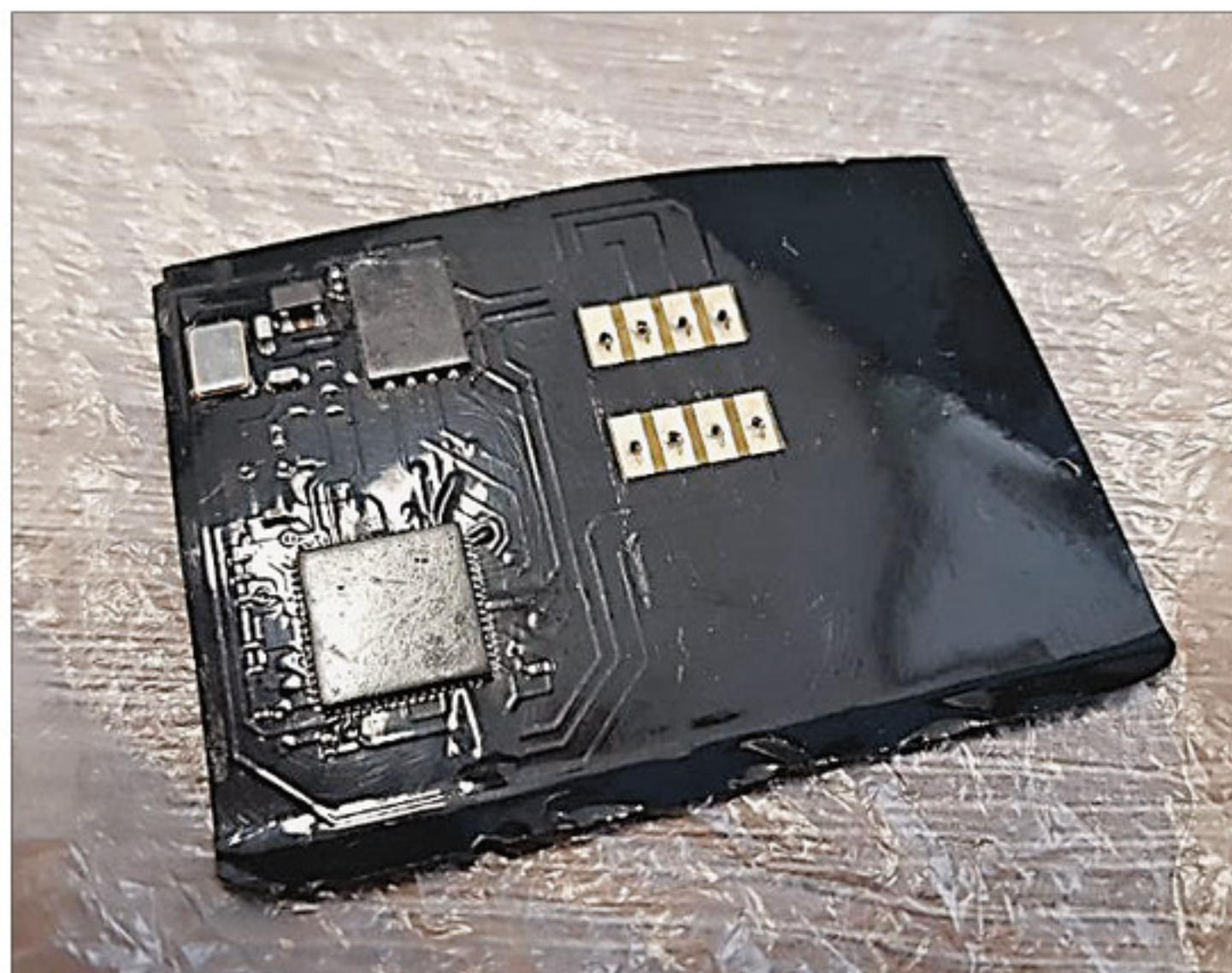
Рисунок 4. Шиммер, устанавливаемый в POS-терминал
