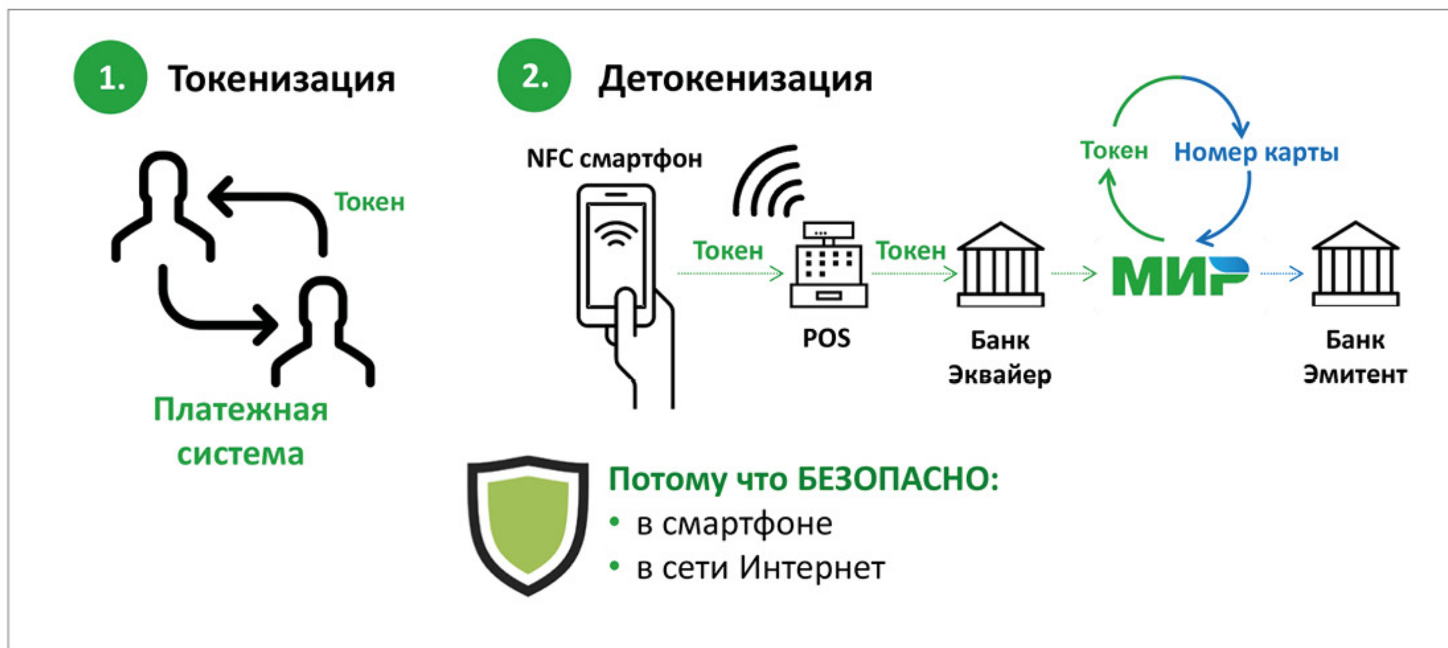
Рисунок 2. Процесс токенизации/детокенизации, реализуемый в платежной системе «Мир»
