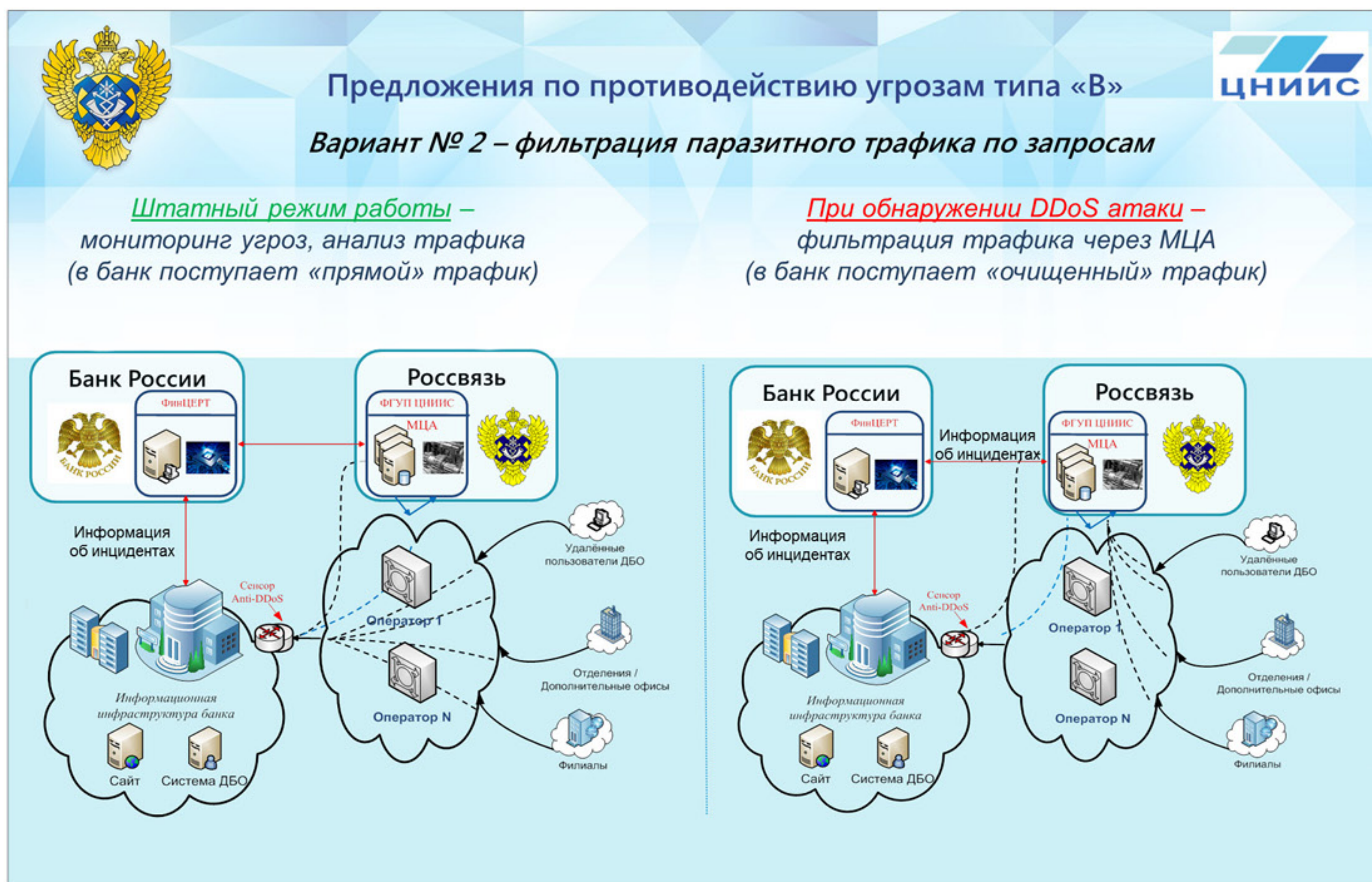
Рисунок 5. Предложения по противодействию угрозам типа «В». Вариант №2 — фильтрация паразитного трафика по запросам
