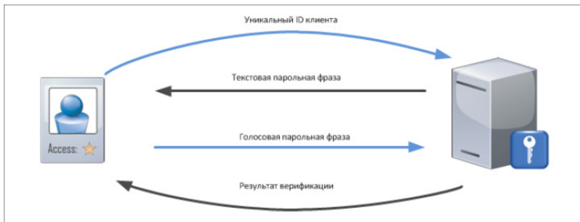
Рисунок 2. Схема работы текстозависимой системы голосовой биометрии с применением динамической парольной фразы
